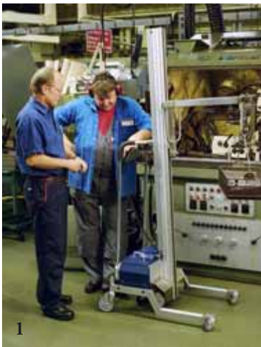
1. Des fourches peuvent être utilisées pour manutentionner des charges suspendues. (PRO120).
