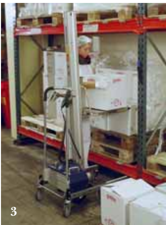
3. Le système de frein centralisé avec réglage directionnel des roues arrière est monté en standard sur le PRO120/150.
