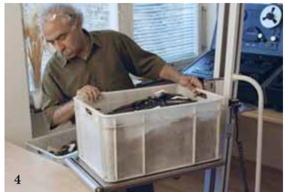
4. Un rouleau de convoyage sur la face avant du plateau facilite les opérations de chargement et de déchargement. (PRO70).
