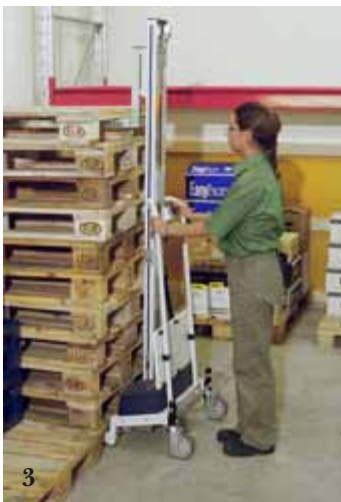
3. PRO70 équipé de fourche extensible pour la manutention de palettes vides. Un plateau amovible permet également la manutention de cartons.
